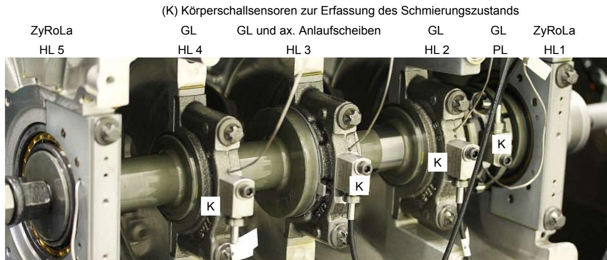
Abbildung 3.18: Applizierte Körperschallsensoren zur Erfassung des Schmierungs Zustands zwischen Prüfzylinder und Gleitlagerung
