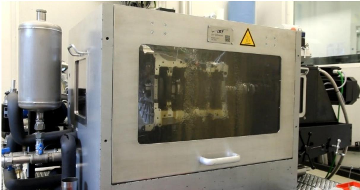
Abbildung 3.9: Dynamischer Lagerprüfstand bei  $5.000 \text{ min}^{-1}$
