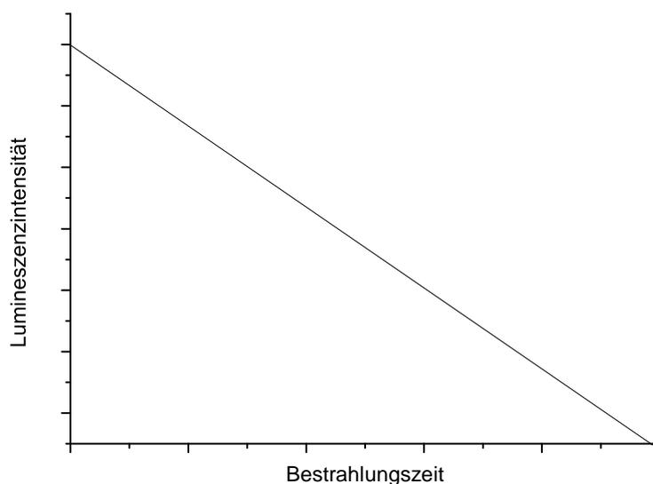
Abbildungung 2.8: Idealisiertes Prinzip des Abbaus einer lumineszierenden Farbstoffschicht in Anwesenheit eines photokatalytisch aktiven Substrats nach einer Bestrahlungszeit.
