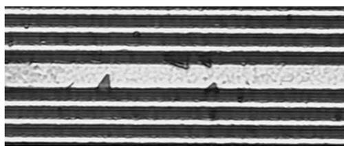
(a) Degradation durch Elektromigration einer kompakten Leitbahn.
