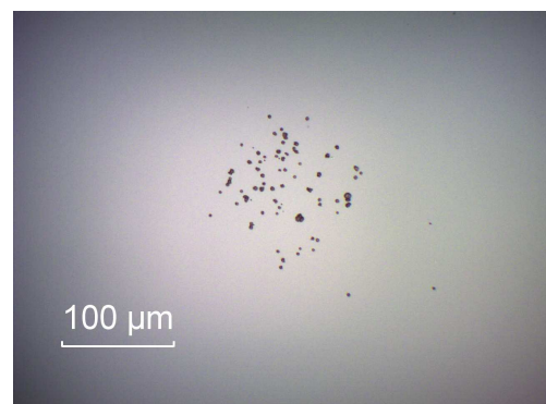
Abbildung 4.10: \text{SiO}_2/\text{Ta}_2\text{O}_5 Mischschicht mit der Bandlücke 6.1 eV - 3PA.
