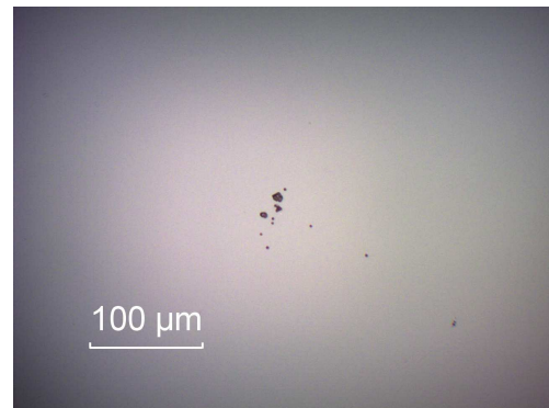
Abbildung 4.11: \text{SiO}_2/\text{Ta}_2\text{O}_5 Mischschicht mit der Bandlücke 7.2 eV - 3PA.
