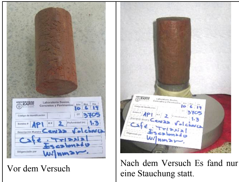
Abbildung 64: Bilder der Bodenprobe AP1-2 (1) vor und nach dem Versuch
