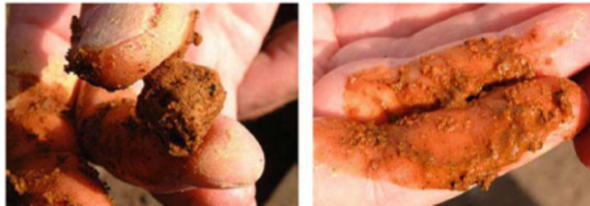
Abbildung 6: Andosol von den Azoren- Portugal. Ungestörte Klumpen auf der linken Seite und gestörte Klumpen auf der rechten Seite. Der Boden erreicht die Fließgrenze, wenn er mit starkem Druck gestört wird, obwohl er im originalen Zustand relativ trocken aussieht [En08].
