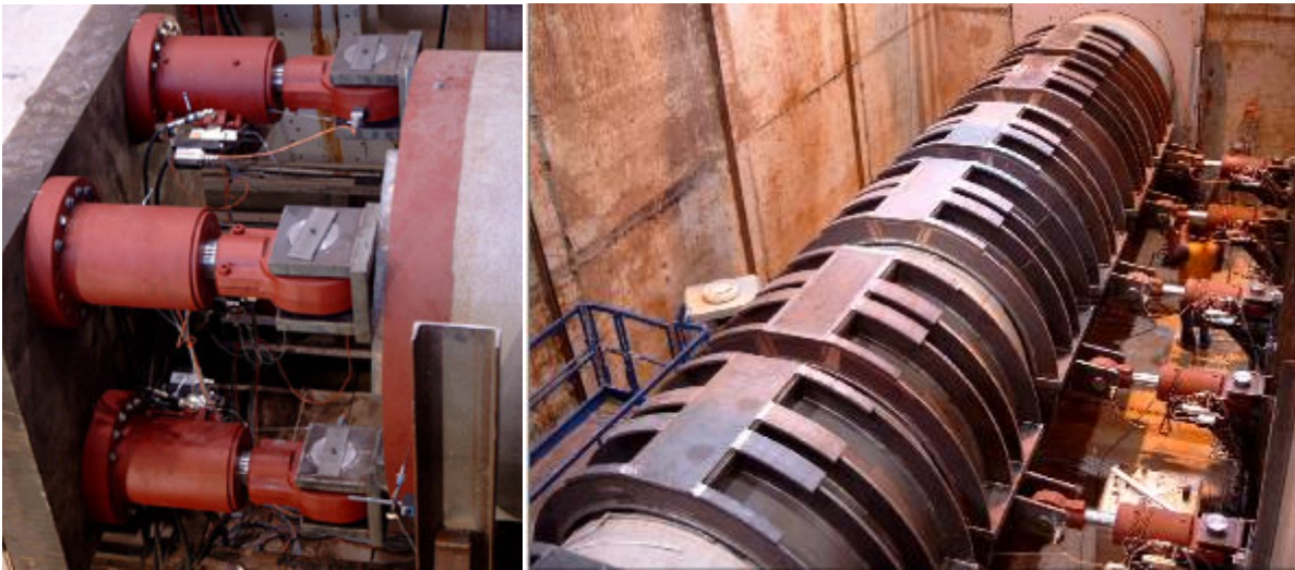
Abbildung 44: Versuchsanlage zur 1:1-Vortriebssimulation unter realitätsnahen Beanspruchungen a) Prinzipskizze: Presszylinder, Bettungsringe, seitliche Hydraulikzylinder, Widerlager b) 1:1-Vorpress-Station DN 1600 (4 x 2 MN) c) 1:1-Rohrstrang DN 1600 ( d_a = 2.100 \text{ mm} , L = 16,0 \text{ m} )
