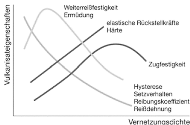
Abb. 6: Schematische Darstellung der Vulkanisationseigenschaften in Abhängigkeit von der Vernetzungsdichte. [9]
