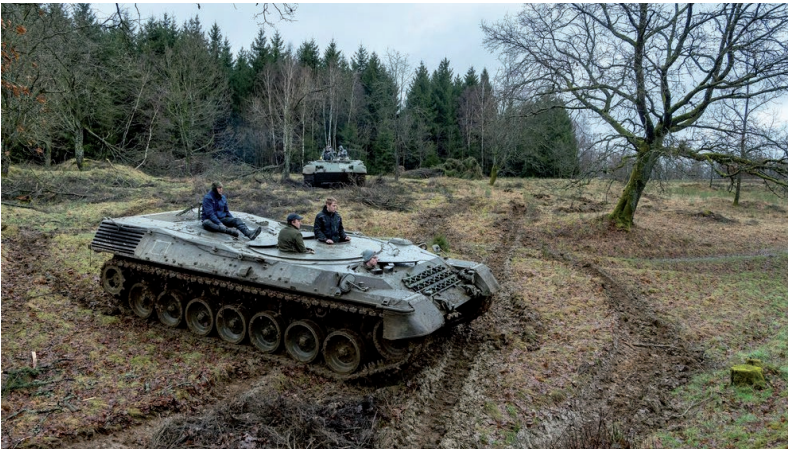
Abb. 115: Ein entmilitarisierter „Pflegepanzer“ bei einem Einsatz in der Trupbacher Heide, einem ehemaligen Truppenübungsplatz. Mit der Maßnahme soll der Boden zur Schaffung von Stillgewässern verdichtet und die Vegetation verjüngt werden (NRW-Stiftung 2022 (a)) (Foto: NRW-Stiftung/ Werner Stapelfeldt (Ausschnitt)).
