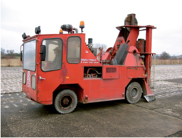
Abb. 156: (links) Betonzertrümmerer auf dem Alten Flugplatz Bonames (Foto: © GTL).
