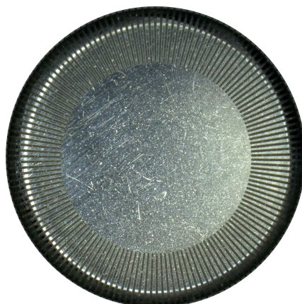
Abb. 26: Polierte Wälzkörperstirnseite mit 165 lasergravierten Strichen zur Drehzahlerfassung
