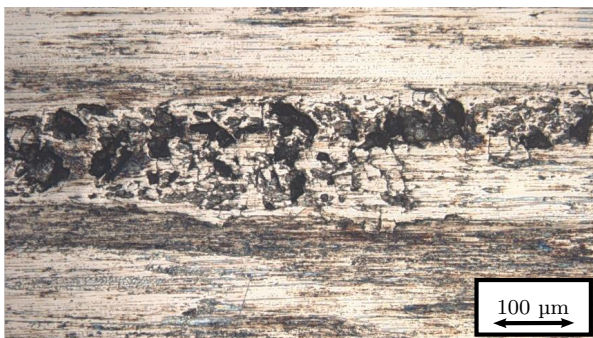
(g) Wälzkörper: Ansmierungen und startender Materialausbruch
