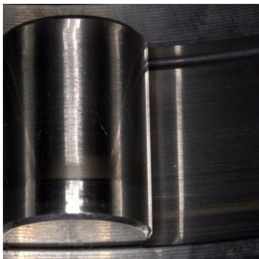
(a) Beschädigter Wälzkörper und Außenring
