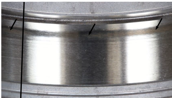
(c) Außenring: umfänglich, unregelmäßig starker Verschleiß
