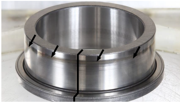
(a) Innenring: Umlaufender Verschleiß
