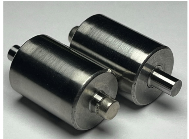
(b) Wälzkörper präpariert mit Passstift und darauf geklebtem Magnet
