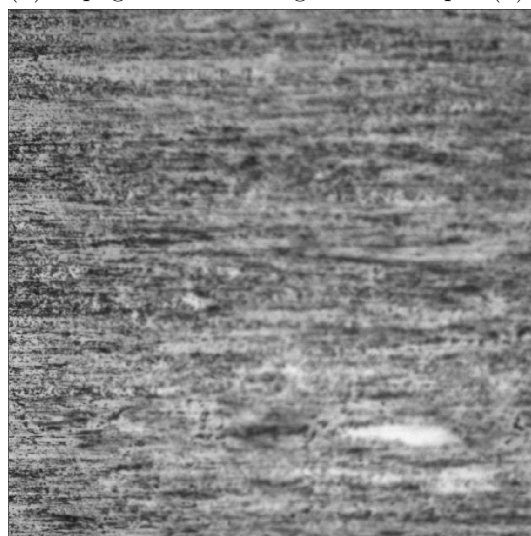
(d) Beschädigte Wälzkörperoberfläche
