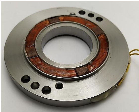
(a) Mit Epoxidharz in Spulenflansch vergossene Kupferspule
