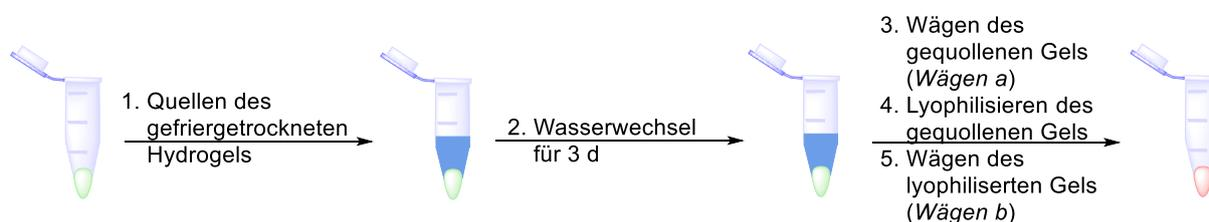
**Schema 3.23:** Schematischer Ablauf der *Swelling*-Methode zur Bestimmung der Wasseraufnahme der Hydrogele.
