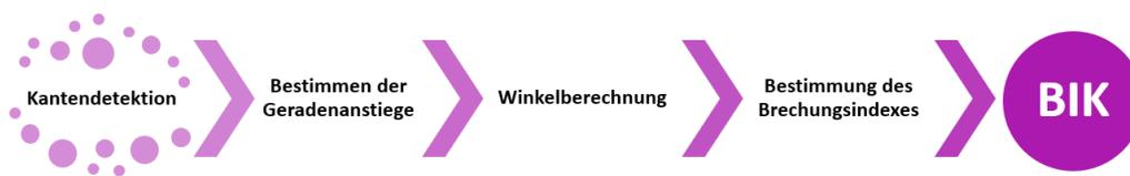
**Abbildung 6.27.:** Schema zur Übersicht des Ablaufes der I-BIK-Methode.
