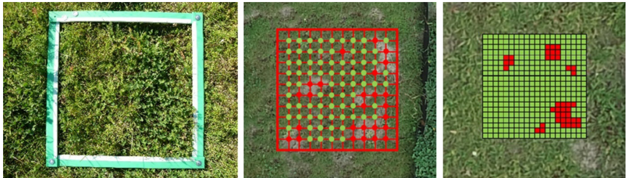
Abbildung 22: Gitterrahmen (links), Ermittlung des Bedeckungsgrads mittels Gitterpunkten (Mitte), Ermittlung der mittleren Fehlstellengröße über Gitterfelder (rechts).
