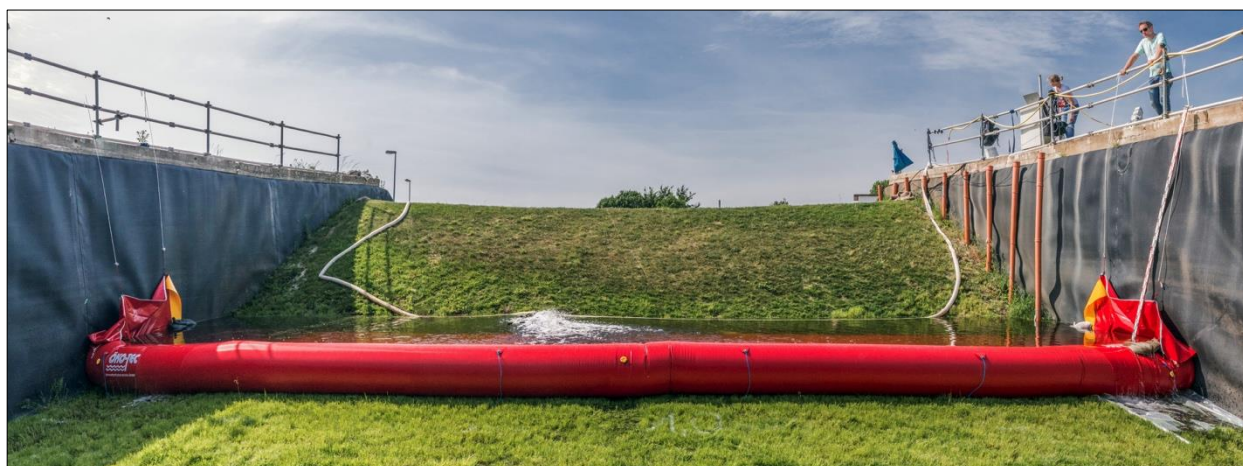
Abb. D-56: Öko-Tec-Schlauchwall – Belastungstest: Volleinstau beim Wasserstand von 0,67 m
