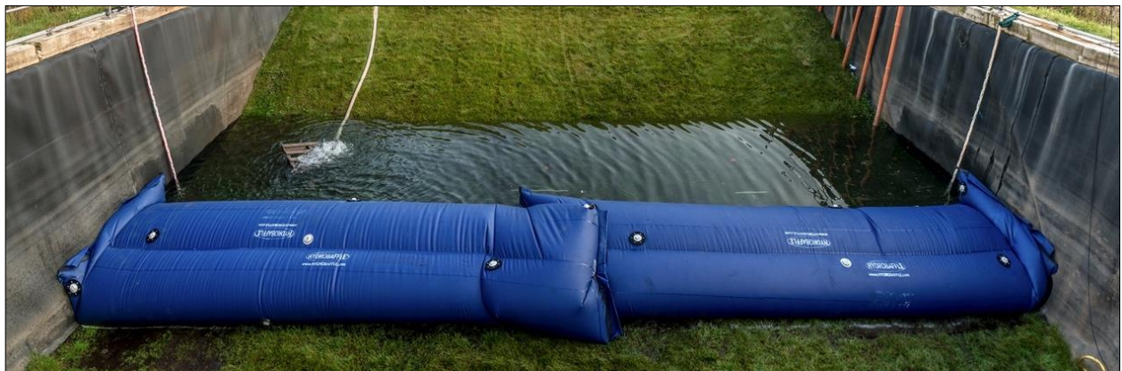
Abb. D-6: Hydrobaffle – Belastungstest: Einstau mit einem Wasserstand von 0,60 m. (Massolle et al., 2018)
