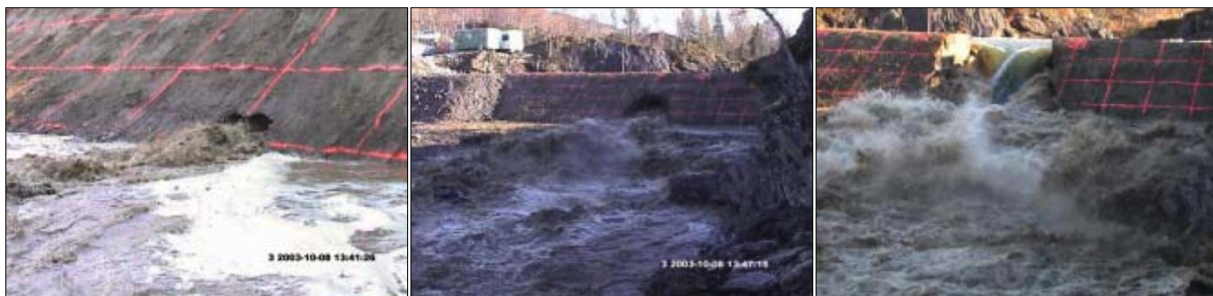
Abb. 3-4: Auswirkung rückschreitender Erosion innerhalb eines Zeitraums von 20 Minuten (Vaskinn et al., 2015)
