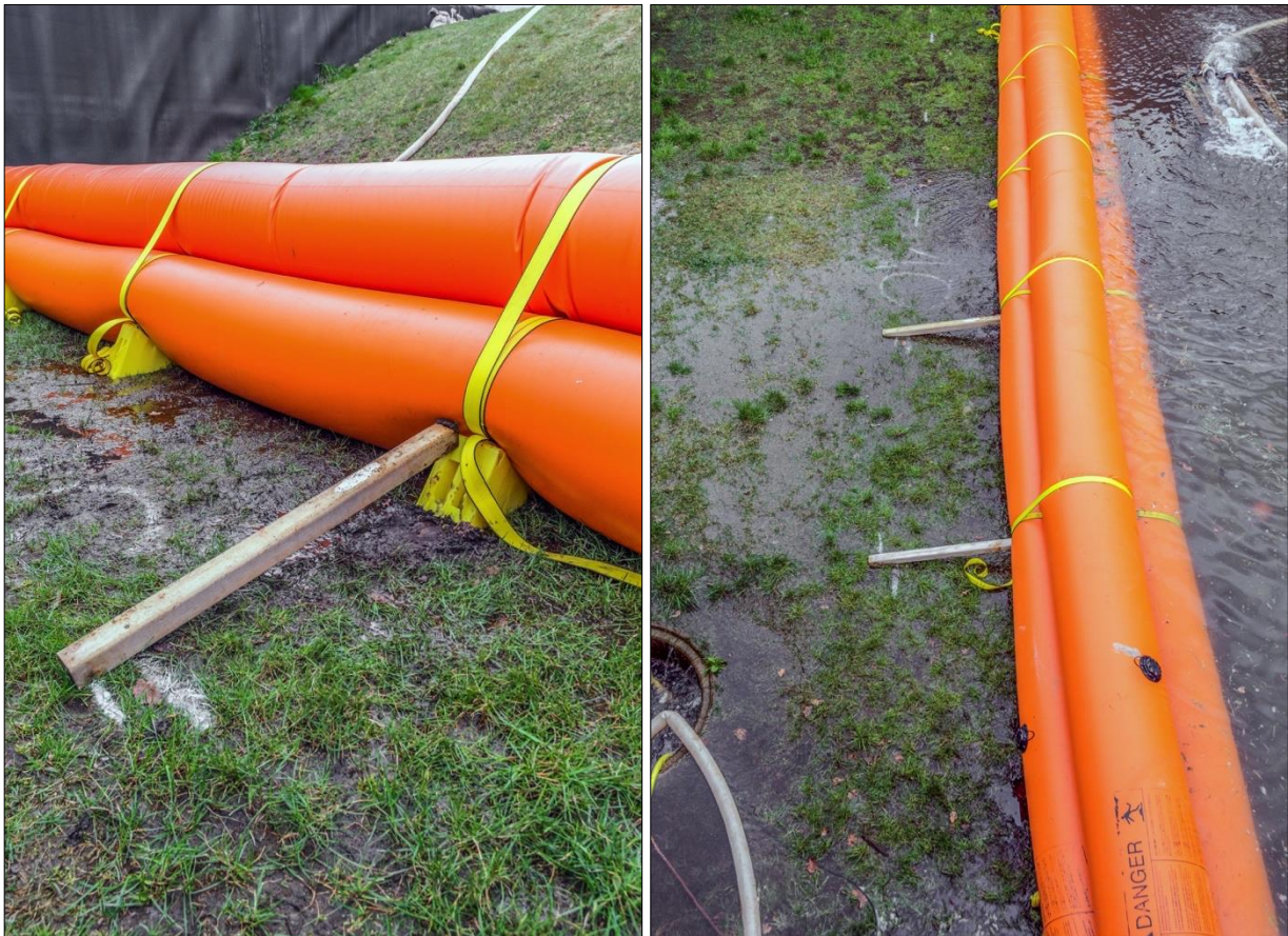
Abb. D-26: Tiger Dam – Belastungstest: Kontrolle der Systemverschiebung mit Holzplatten (links) Systemverschiebung bei einem Wasserstand von etwa 50 cm
