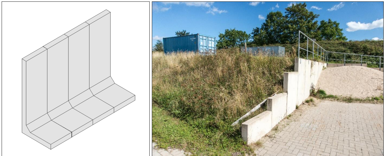
Abb. A-6: Betonfertigteil einer Winkelstützwand (links); Eingebaute Winkelstützwand mit Betonfertigteilen (rechts)
