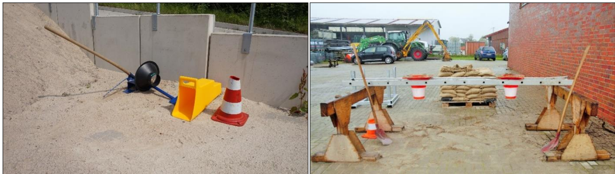
Abb. 2-14: Werkzeug zum Befüllen von Sandsäcken (links); Provisorische Hilfskonstruktion für die Sandsackbefüllung (rechts); (Fotos: Lena Lankenau)
