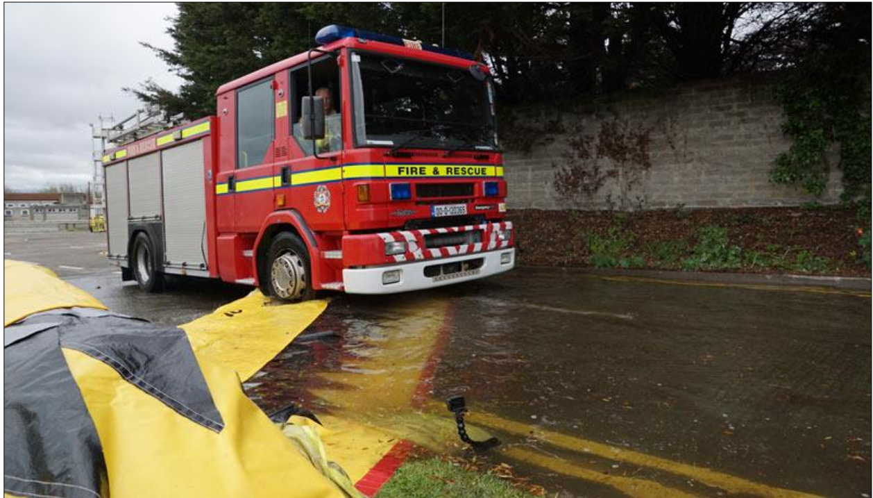
Abb. 6-17: Querung eines eingestaute n Klappsyste \ddot{u} ms mit einem Feuerwehrfahrzeug (Megasecur, 2021)
