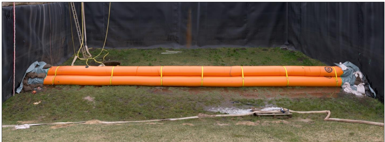
Abb. D-23: Tiger Dam – Aufbau: Fertiggestellte Schutzlinie ohne vorgelagerter Dichtungsbahn und ohne Bodenverankerung
