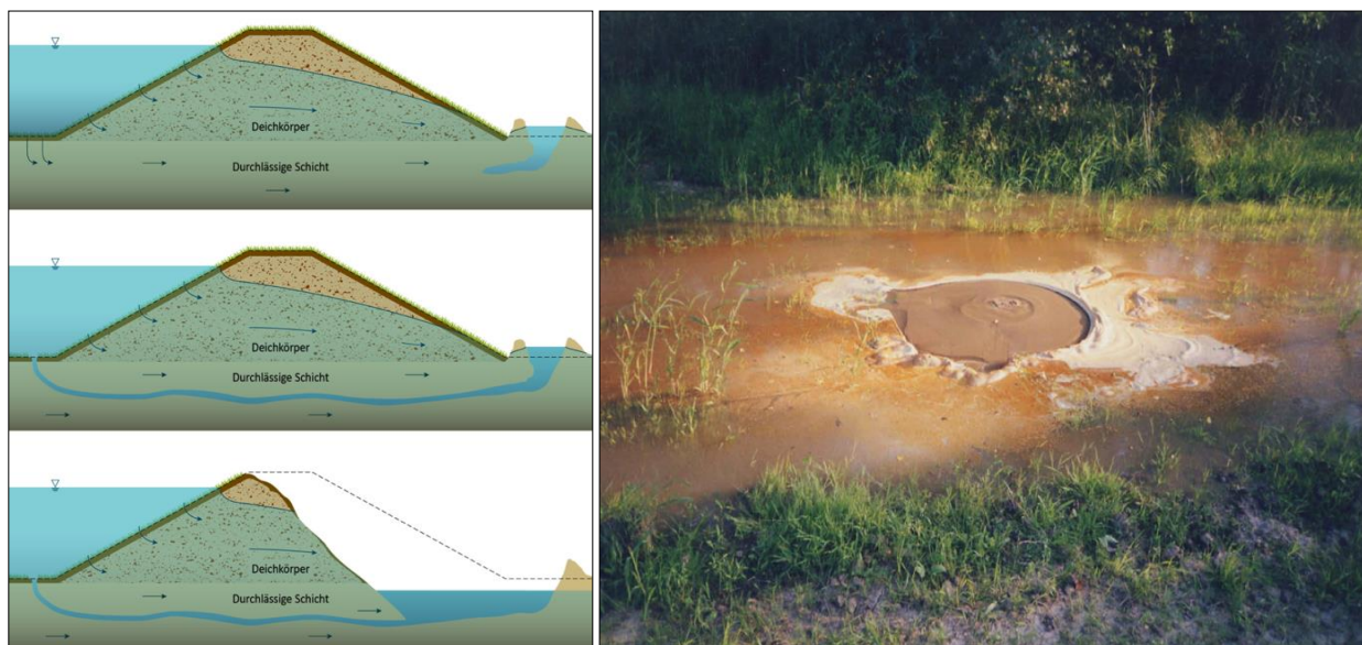
Abb. 3-6: Schematische Darstellung des Erosionsgrundbruches (links); Ausbildung eines Quelltrichters (rechts) (TLUG, 2011)
