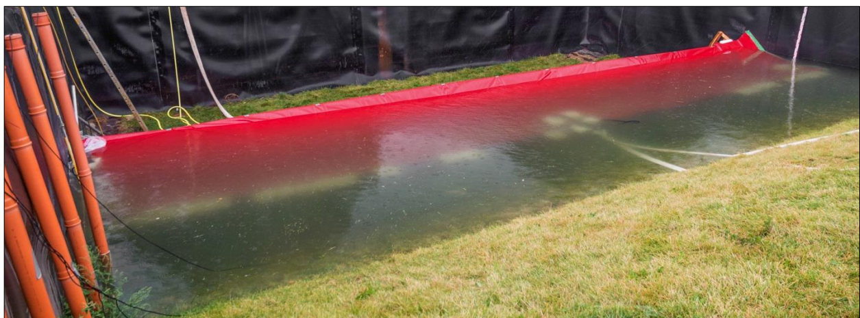
Abb. D-130: Plettac Aqua Defence – Belastungstest: Einstau mit einem Wasserstand von 1,0 m
