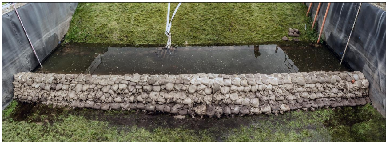
Abb. 7-7: Sandsackdamm – Einstau mit einem Wasserstand von 0,60 m, (Massolle et al., 2018)
