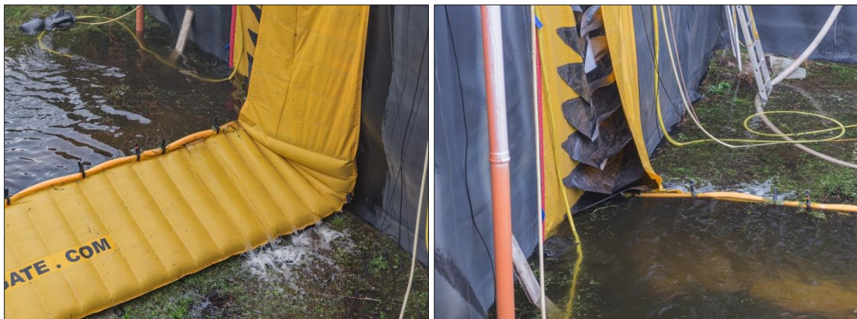
Abb. D-113: Megasecur Water-Gate – Belastungstest: Überströmung des Randbereichs mit Blick von der Landseite (links) und mit Blick von der Wasserseite (rechts)
