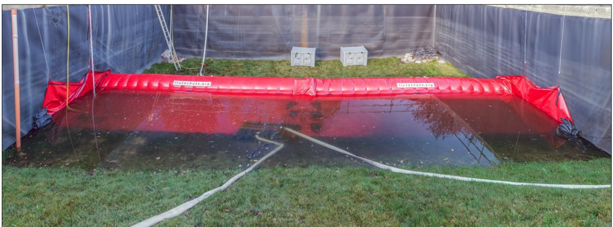
Abb. D-67: Flutschutz-Deichkade – Belastungstest: Eintauch mit einem Wasserstand von 0,60 m
