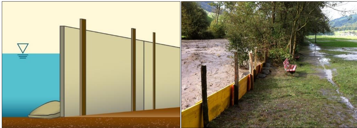
Abb. 6-20: Schematische Darstellung des Tafelsystems (links); Tafelsystem im Einsatz (rechts), (Planat, 2020)
