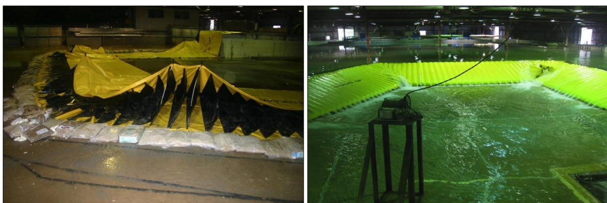
Abb. D-104: Megasecur Water-Gate – Testaufbau mit innenliegenden Aussteifungen (links); Überströmung während der Testphase (rechts), (Ward, 2015)
