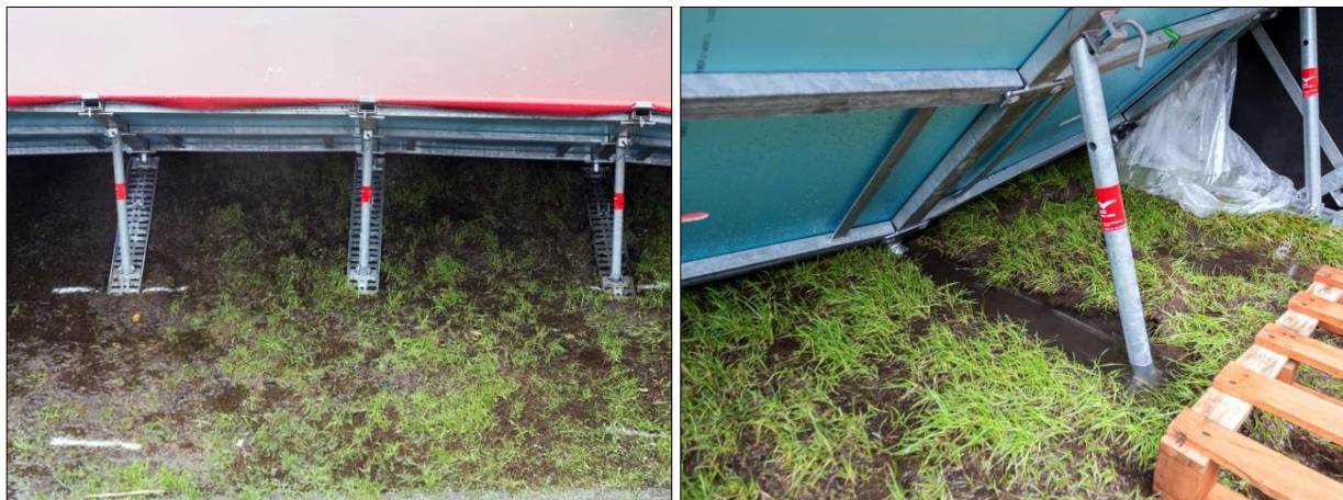
Abb. D-129: Plettac Aqua Defence – Belastungstest: Beginn vom Eindrücken der Stützbocke in den Untergrund bei einem Wasserstand von 0,95 m (links); Eingesunkener Stützbock in den aufgeweichten Untergrund (rechts), (Massolle et al., 2018)
