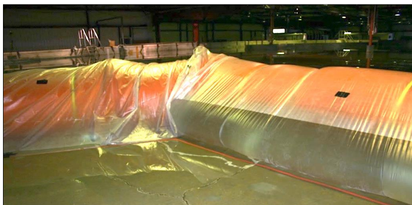
Abb. D-16: Tiger Dam – Beschädigte Dichtungsbahn im linken Bereich des Testaufbaus (Ward, 2013)
