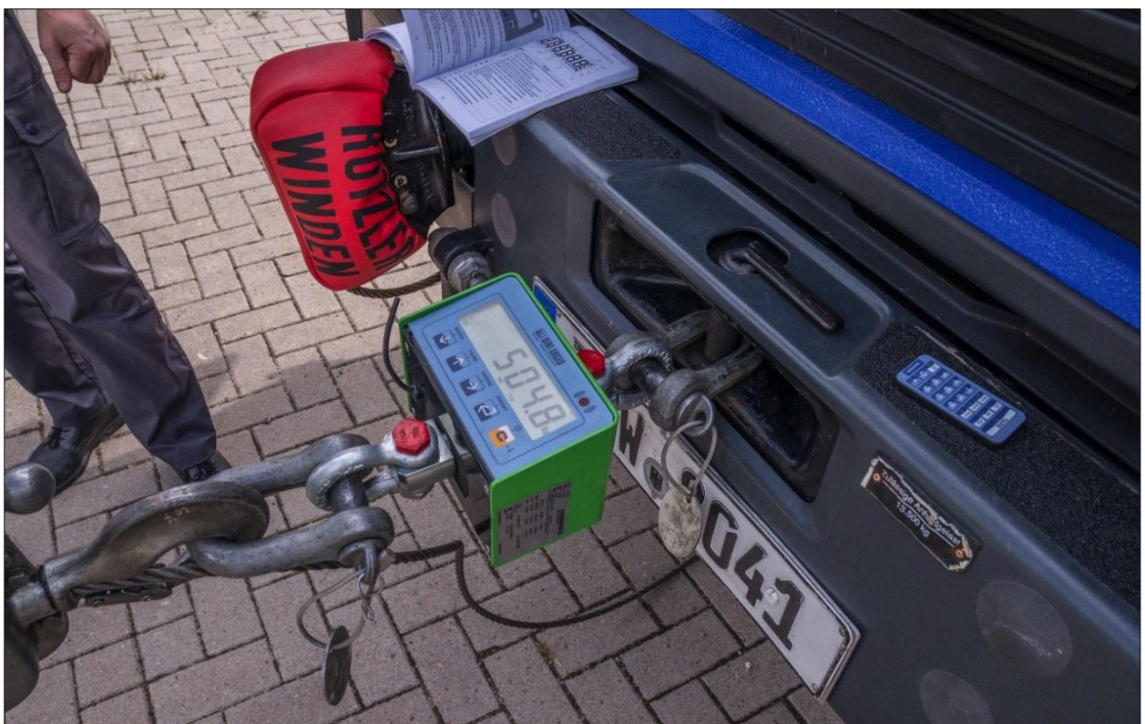
Abb. B-28: Maximal aufgebrachte Zugkraft von 5,05 kN (etwa 505 kg)
