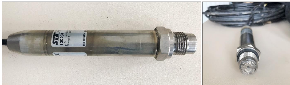
Abb. A-38: Druckmessdose für Wassersäulenmessung
