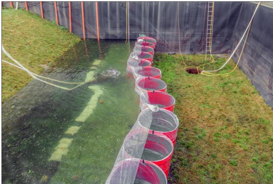
Abb. D-81: Aquariwa – Belastungstest: Einstau mit einem Wasserstand von 1,0 m
