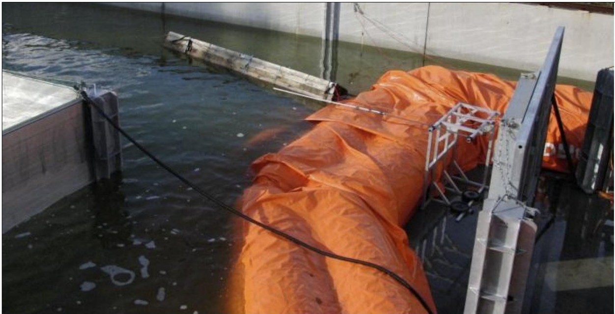
Abb. D-34: Mobildeich – Belastungstest im Versuchsbecken der TU-Hamburg (Gabalda et al., 2012)
