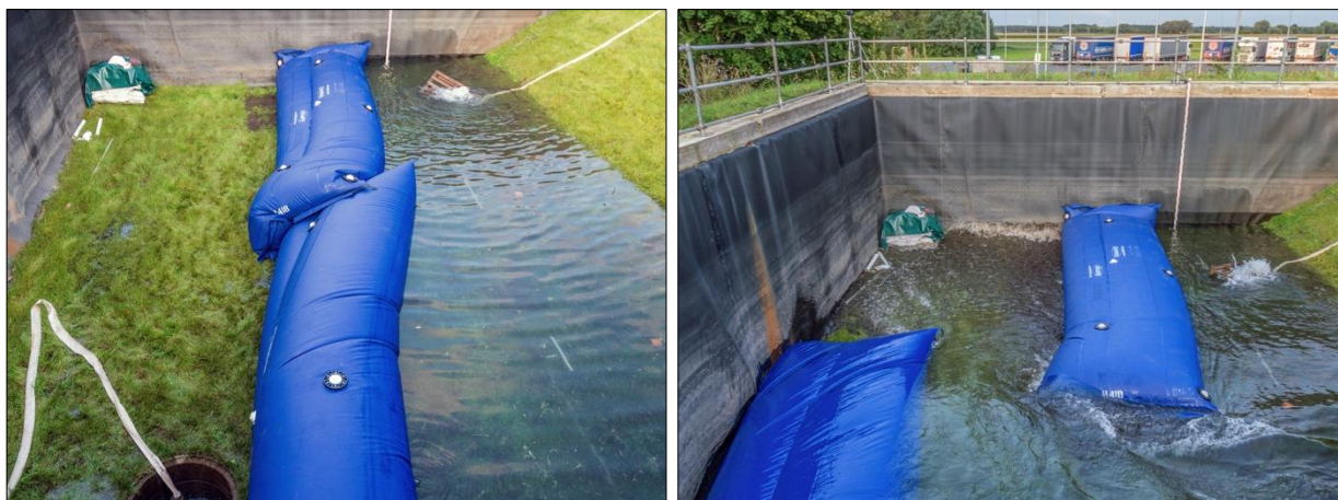
Abb. D-9: Hydrobaffle – Belastungstest: Starke Systemverdrehung kurz vor dem Versagen (links); Systemversagen bei einer Einstauhöhe von 0,76 m (rechts)
