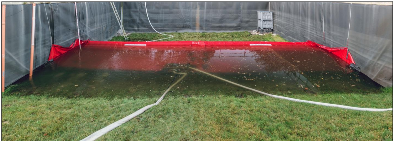
Abb. D-69: Flutschutz-Deichkade – Belastungstest: Volleinstau beim Wasserstand von 0,90 m
