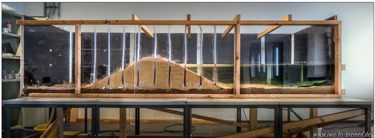
Abb. A-41: Versuchsstand mit Modelldeich im Maßstab 1:10 im Nasslabor der Hochschule Bremen
