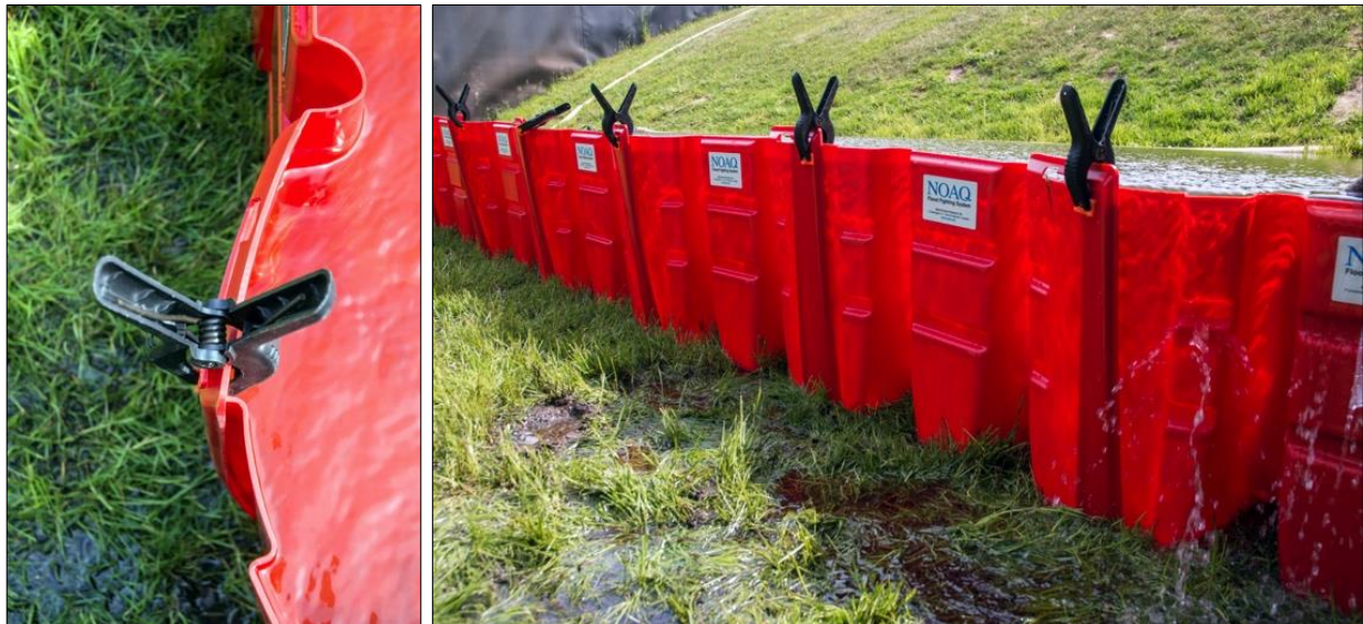
Abb. D-143: NOAQ Boxwall – Belastungstest: Ausrundung des Stoßbereichs infolge erhöhter Belastung (links); Überströmung des Randbereichs (rechts)
