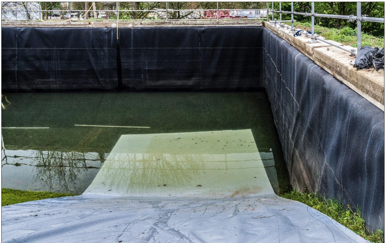
Abb. 5-14: Einstauversuch 1 – Lage eines Elementes nach der Versuchsdurchführung
