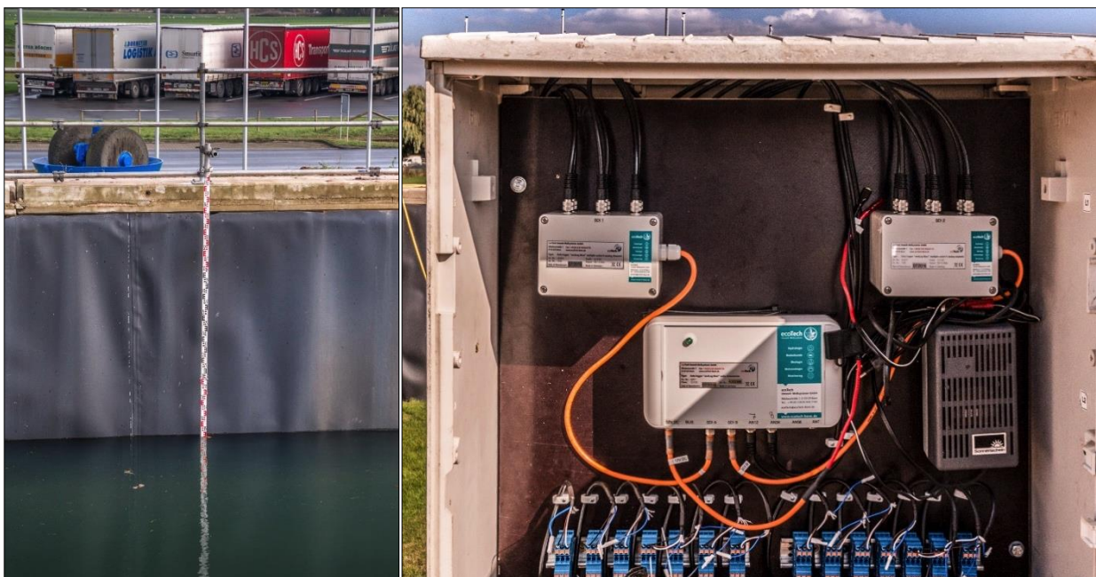
Abb. B-33: Einsatz einer Messlatte im Einstaubereich (links); Angeschlossene Druckmessdosen an den Datenloggern im Messschrank (rechts)
