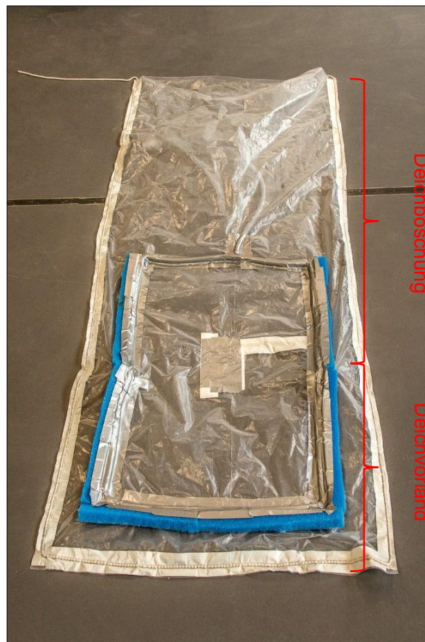
Abb. 5-1: Labormodell des Entwässerungssystems – Test 1
