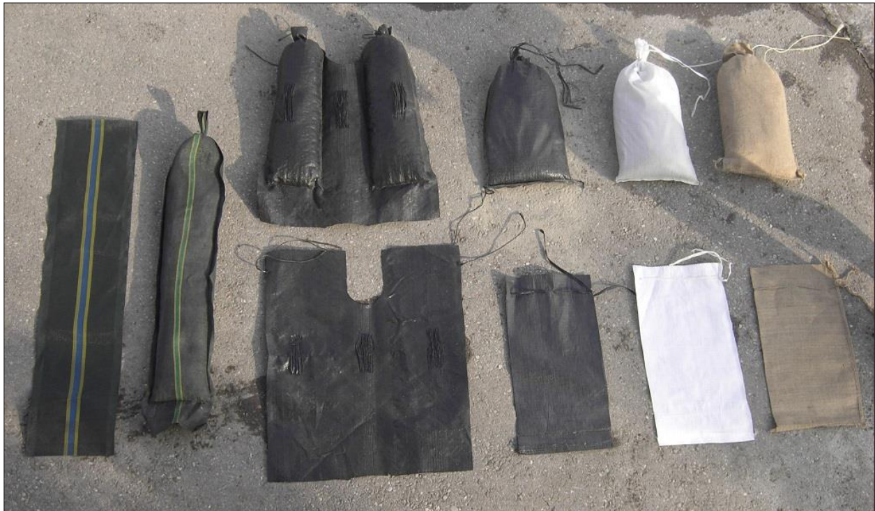
Abb. 2-12: Variation von Sandsäcken, Von links nach rechts: Sandsackschlauch, Tandemsandsack, PP-Sandsack (uv-beständig), PP-Sandsack, Jutesandsack (König, 2020)
