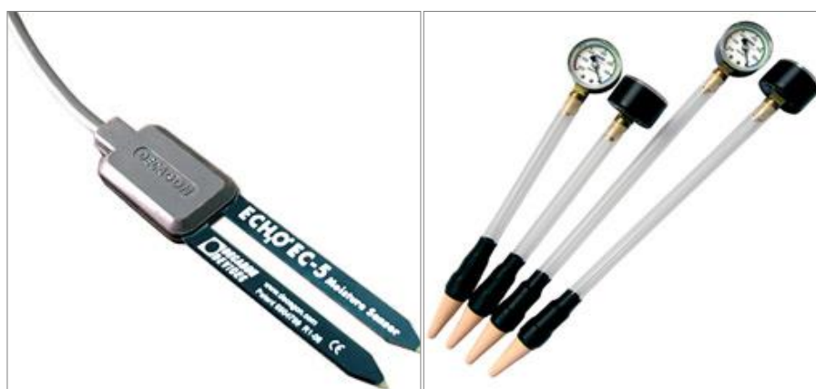
Abb. A-37: FDR Sensor für Bodenfeuchtemessung (links); Tensiometer für Bodenfeuchtemessung (rechts), (MMM Tech-Support, 2020)
