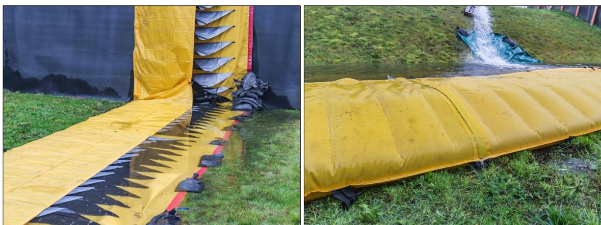
Abb. D-109: Megasecur Water-Gate – Belastungstest: Eigenständiges Aufklappen des Systems infolge zunehmender Einstauhöhe (links); Aktivierung der innenliegenden Sperrwände gegen weiteres Aufklappen (rechts)
