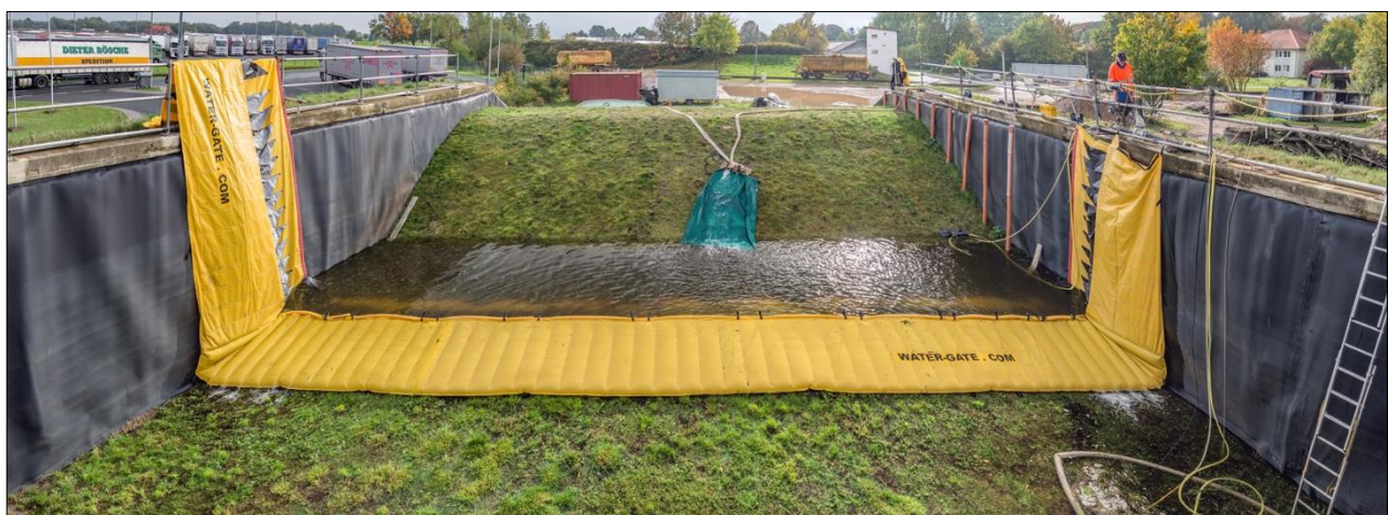
Abb. D-114: Megasecur Water-Gate – Belastungstest: Überströmung der Randbereiche
