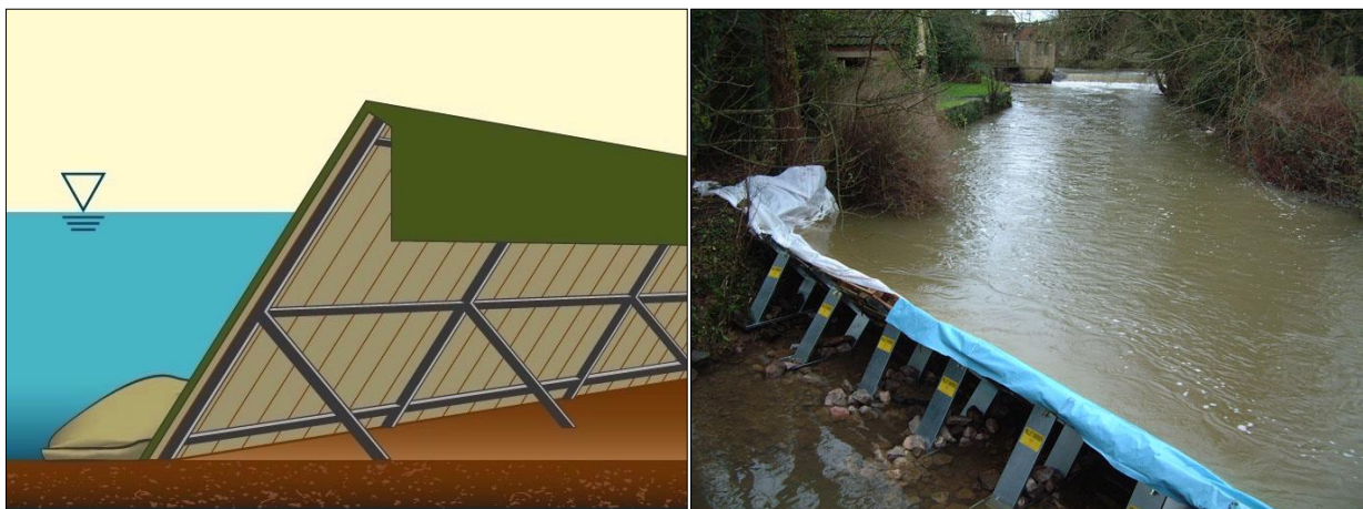
Abb. 6-18: Schematische Darstellung eines Bocksystems (links); Bocksystem im Einsatz (rechts), (Planat, 2020)
