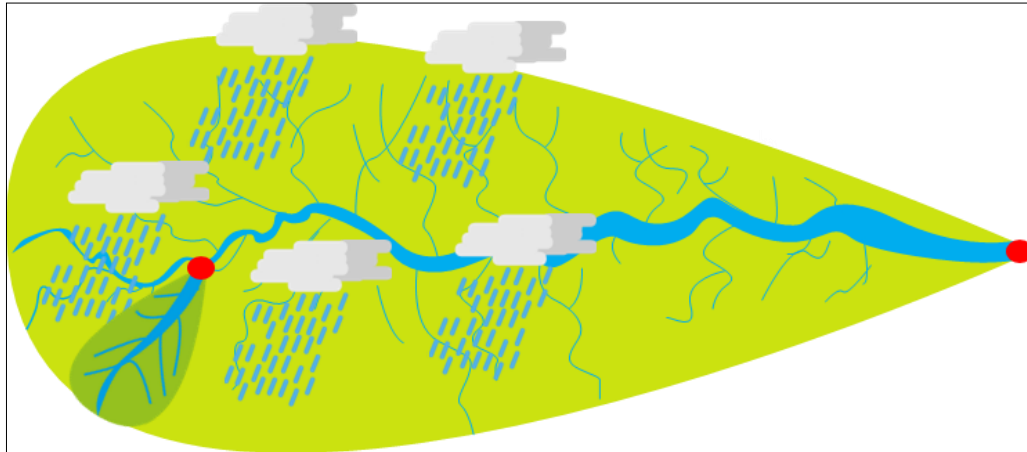
Abb. 2-3: Schematische Darstellung eines Flusseinzugsgebiets (Koppe, Lankenau, 2018a)
