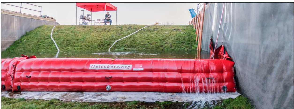
Abb. D-70: Flutschutz-Deichkade – Belastungstest: Überlauf bei einem Wasserstand von etwa 0,91 m
