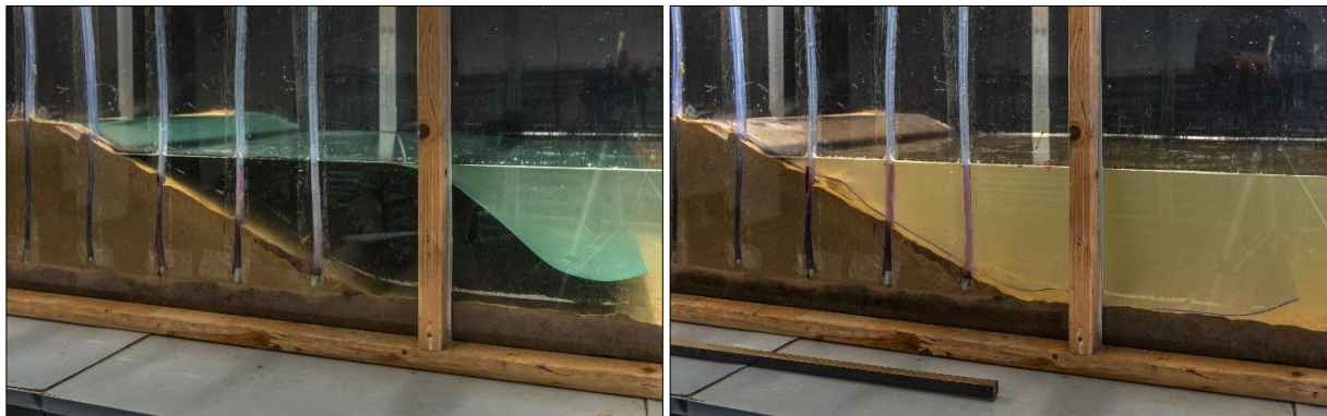
Abb. 5-5: Links: Aufschwimmen der Probe Nr. 4; rechts: Schlechtes Anschmiegen an den Untergrund Probe Nr. 6
