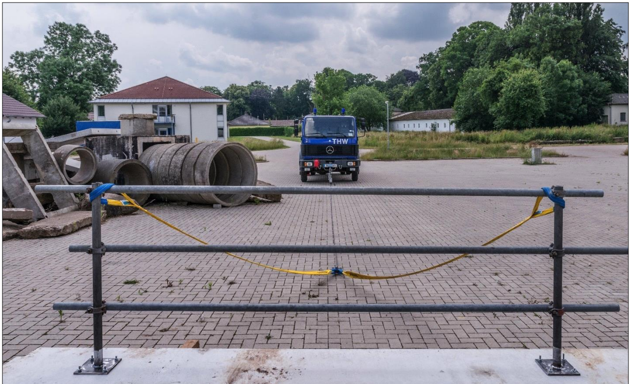
Abb. B-27: Zugversuch am Geländer
