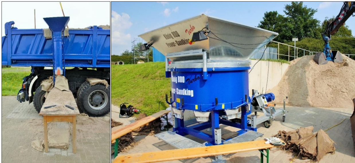
Abb. 2-15: Vorrichtung eines Sandsackfülltrichters an einem Lastkraftwagen-Kipper (links); Sandsackfüllmaschine (rechts); (Fotos: Lena Lankenau)
