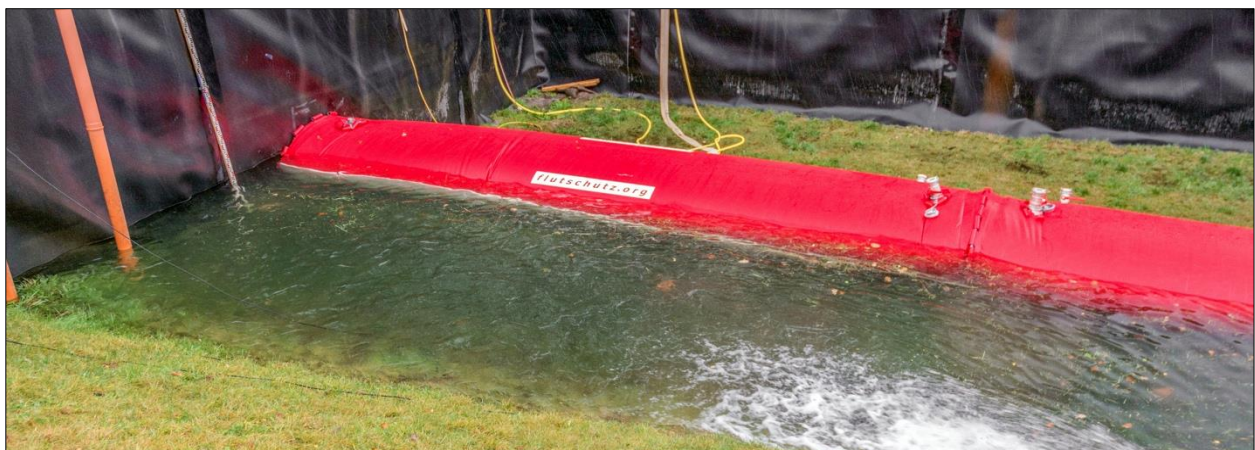
Abb. 7-20: Flutschutz-Doppelkammerschlauch – Belastungstest: Aufschwimmen der PE-Schaummatte bei einem Wasserstand von 0,95 m kurz vor dem Versagen
