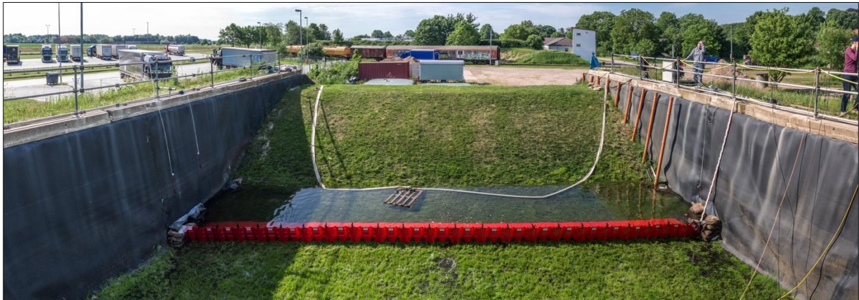
Abb. D-141: NOAQ Boxwall – Belastungstest: Einstau mit einem Wasserstand von 0,50 m, (Massolle et al., 2018)
