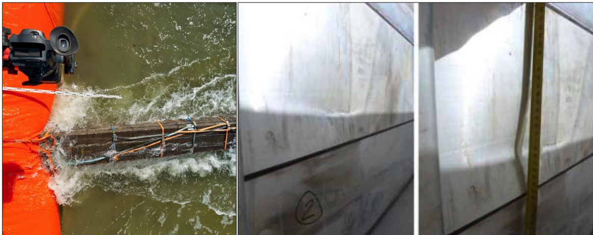
Abb. 6-38: Treibgut-Anpralltest am wassergefüllten Schlauchsystem Flutschutz-Doppelkammerschlauch (links), (Foto: Bärbel Koppe); Verformter Dammbalken infolge eines Anpralltests (rechts), (Galbada et al., 2012)
