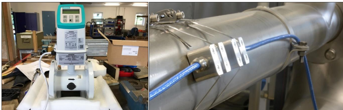
Abb. A-39: Magnetisch-Induktiver Durchflussmesser MID (links); Ultraschall-Durchflussmesser USD (rechts), (Nivus, 2020)
