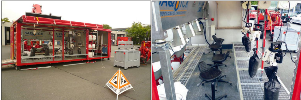
Abb. 2-16: Abrollbehälter "Sandsackbefüllung" von der Feuerwehr Hannover mit integrierter Sandsackfüllmaschine und Nähmaschinen zum Schließen der Sandsäcke (Lange et al., 2013)
