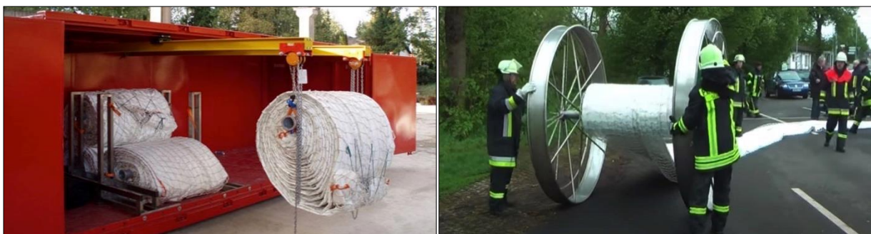
Abb. 6-10: Spezialvorrichtung für die Installation eines Schlauchsystems (Mobildeich, 2020)
