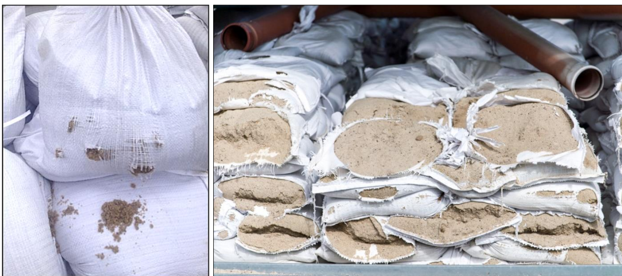
Abb. 6-7: Defekter Kunststoffandsack ohne UV-Beständigkeit nach einer 10-tägigen witterungsausgesetzter Lagerung (links) und nach etwa 3 Monaten (rechts)
