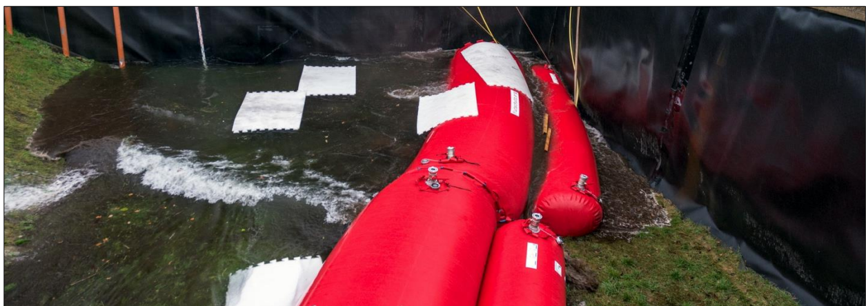
Abb. 7-21: Flutschutz-Doppelkammerschlauch – Belastungstest: Versagen des Systems bei einem Wasserstand von 0,97 m
