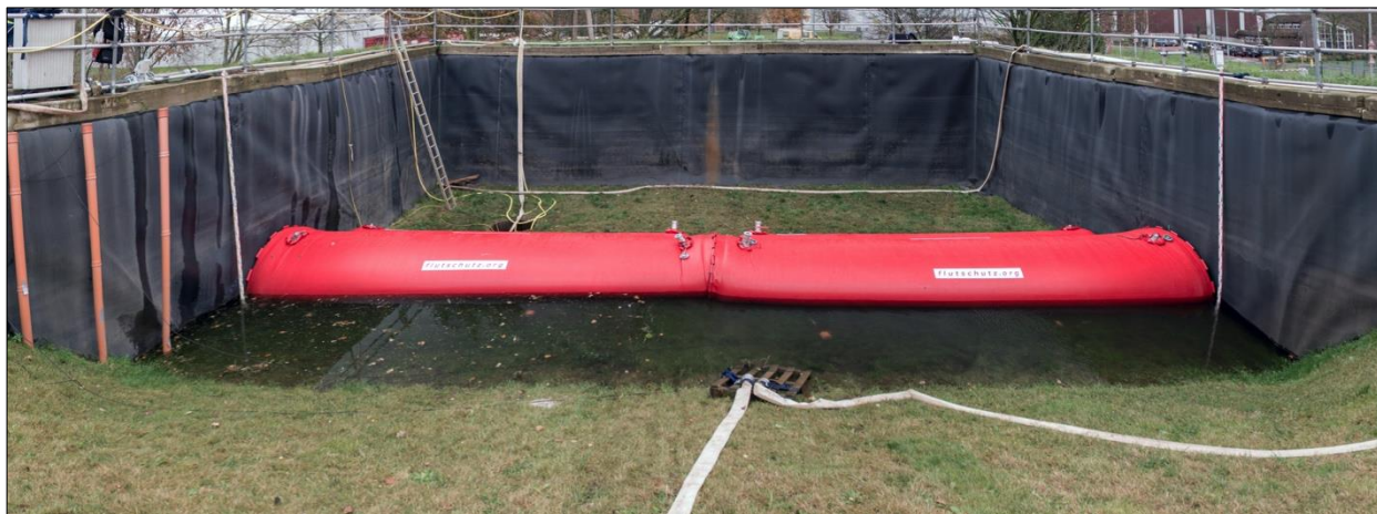
Abb. 7-18: Flutschutz-Doppelkammerschlauch – Belastungstest: Einstau mit einem Wasserstand von 0,60 m
