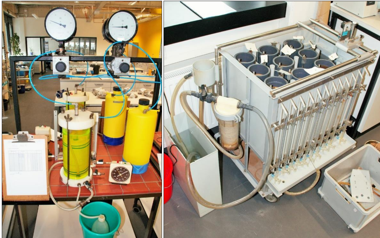
Abb. A-33: Versuchsaufbau Triaxialzelle (links); Versuchsaufbau Permeameter, Geotechnisches Labor der Hochschule Bremen (rechts)
