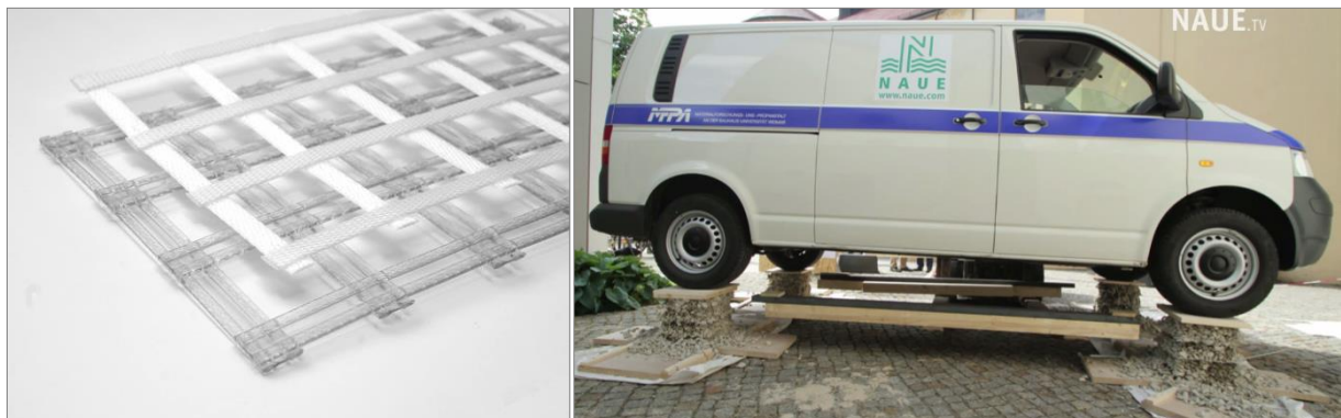
Abb. A-8: Secugrid Q-Matte der Firma Naue (links); Stabilitätsversuch mit Secugrid der Firma Naue (rechts), (Naue, 2020)
