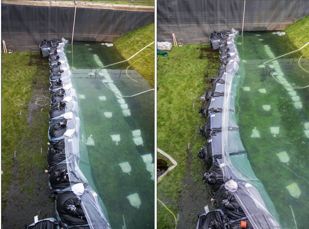
Abb. D-95: Indutainer – Belastungstest: Erhebliche Auslenkung (links) und endgültiges Versagen des Indutainer-Systems bei einem Wasserstand von 1,05 m (rechts)
