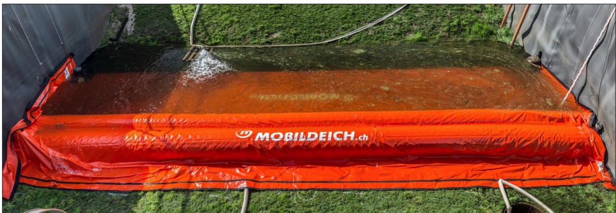
Abb. D-42: Mobildeich – Belastungstest: Volleinstau des Mobildeichs, (Massolle et al., 2018)
