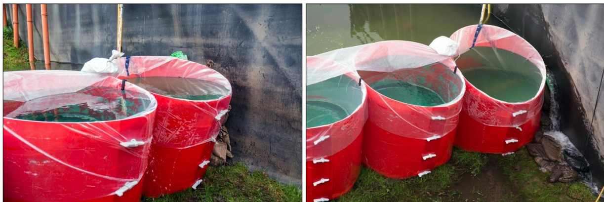
Abb. D-82: Aquariwa – Belastungstest: Schiefstellung und Wasserverlust aus dem Foliensack bei einem Wasserstand von 1,07 m (links); Versagen der Randabdichtung infolge der erhöhten Schiefstellung des Systems (rechts)
