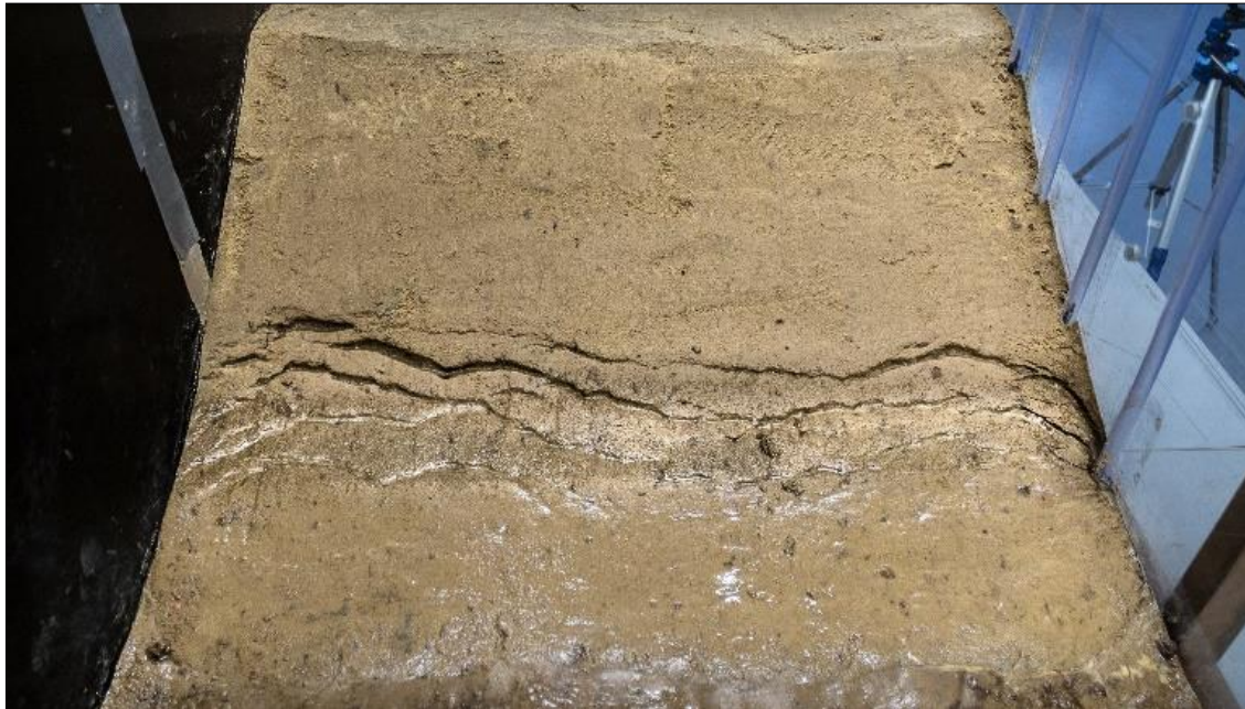
Abb. A-42: Rutschung am Deichfuß des Modelldeichs im Maßstab 1:10 bei bordvollem Einstau
