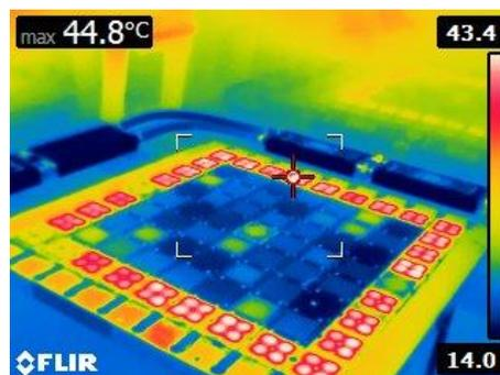
*Abbildung 3.6: Aufnahme mit einer Wärmebildkamera (FLIR) des LED-Feldes bei der Simulation des ASTM G173-03-Spektrums.*
