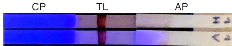
**Abbildung 46:** LFAs zur Hybridisierung (oben) und Verdrängung (unten) durch OTA (40 µM), bestrahlt mit UV-Licht (366 nm). CP=Conjugate Pad, TL= Testlinie, AP=Absorbent Pad. A<sub>25</sub>-O Konjugat mittels Einfrieren bei - 20 °C, CP vorbehandelt mit BB ohne CaCl<sub>2</sub>, 1 % OVA, 2 % Saccharose.
