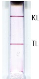
**Abbildung 45:** Lateral Flow Assay mit einer Testlinie und einer Kontrolllinie. A<sub>25</sub>-A Konjugat, hergestellt mittels pH-Erniedrigung. Die Oligonukleotide der TL und KL sind mittels Streptavidin (25 µM)-Biotin (50 µM)-Kupplung immobilisiert. Als TL sind cOligo-Moleküle immobilisiert, als KL T<sub>25</sub>-Moleküle.
