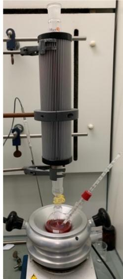
Abbildung 55: Aufbau zur AuNP-Synthese.
