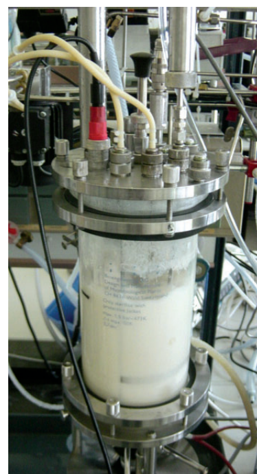
Abb. 7. Biokonversion von Limonen zu Perillasäure im Laborreaktor. Der Mikroorganismus toleriert erhöhte Volumenanteile oberhalb der Löslichkeitsgrenze des Terpens, so dass sich beim Rühren im Bioreaktor eine milchig-trübe Emulsion bildet.
